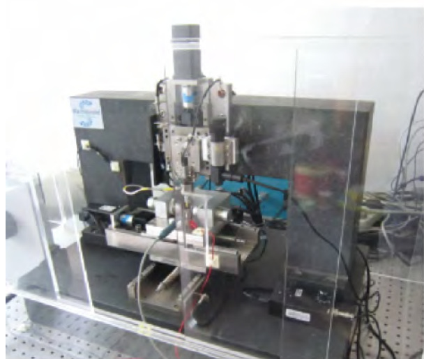
图 2 (左):力电磁耦合微纳米压痕仪;(右)模块化设计原理图 [15]
